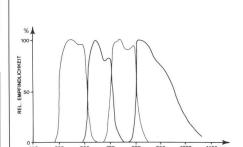
Abb. 3 Spektrale Empfindlichkeitskurven des LANDSAT-Multispektral-Scanners
