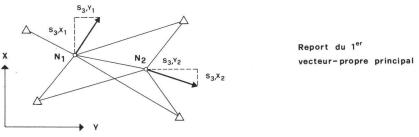
Fig. 2 Schéma de calcul et de report des vecteurs-propres principaux
