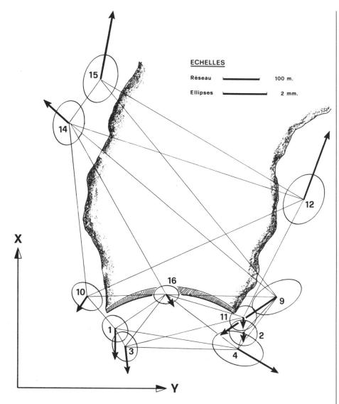
Fig. 8 Réseau de contrôle du barrage de l'Edersee (D), avec les points de base, le premier vecteur-propre principal et les ellipses de confiance
