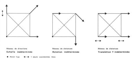
Fig. 3a 3 réseaux avec une indétermination isolée du datum géodésique
