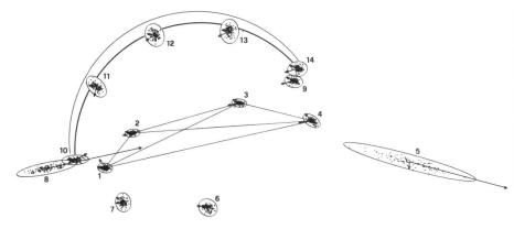
Fig. 4 Réseau de contrôle du barrage de Montsalvens, avec les deux premiers vecteurs-propres principaux, les ellipses de confiance et 100 simulations
