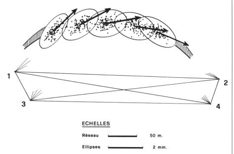
Fig. 9 Barrage de l'Edersee: réseau partiel avec 4 piliers d'observation, 5 points du parement, le premier vecteur-propre principal, les ellipses de confiance et 100 simulations
