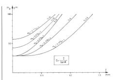
Abb. 4 Mittlerer Fehler m<sub>p</sub> des Orthophotos in Abhängigkeit des Höhenlinienintervalles I, der Schlitzlänge S (=I/tan \(\bar{\alpha}\), der Geländecharakteristik T und des Höhenlinienfehlers mh, wobei sich  $m_p$ , c, I, S, T und  $m_h$  auf das bei der Datenverarbeitung verwendete Bild beziehen ( $\bar{\alpha}$  ist die durchschnittliche Geländeneigung)
