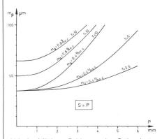
Abb. 1 Mittlerer Fehler  $m_p$  des Orthophotos in Abhängigkeit des Profilabstandes P, der Schlitzlänge S(= P), der Geländecharakteristik T und des Profilierfehlers  $m_a$ , wobei sich  $m_p$ , c, P, S, T und  $m_a$  auf das bei der Datenerfassung verwendete Bild beziehen.
