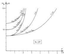
Abb. 3 Mittlerer Fehler m<sub>p</sub> des Orthophotos in Abhängigkeit des Profilabstandes P, der Schlitzlänge S(= 2P), der Geländecharakteristik T und des Profilierfehlers  $m_{\text{a}}$ , wobei sich  $m_{\text{p}}$ , c, P, S, T und  $m_{\text{a}}$  auf das bei der Datenerfassung verwendete Bild beziehen.
