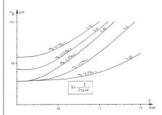
Abb. 5 Mittlerer Fehler m<sub>p</sub> des Orthophotos in Abhängigkeit des Höhenlinienintervalles I, der Schlitzlänge S (= $I/[2 \tan \bar{\alpha}]$ ), der Geländecharakteristik T und des Höhenlinienfehlers  $m_h$ , wobei sich  $m_p$ , c, I, S, T und  $m_h$  auf das bei der Datenerfassung verwendete Bild beziehen (ā ist die durchschnittliche Geländeneigung)
