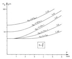
Abb. 2 Mittlerer Fehler m<sub>p</sub> des Orthophotos in Abhängigkeit des Profilabstandes P, der Schlitzlänge S(=P/2), der Geländecharakteristik T und des Profilierfehlers  $m_a$ , wobei sich  $m_p$ , c, P, S, T und  $m_a$  auf das bei der Datenerfassung verwendete Bild beziehen.
