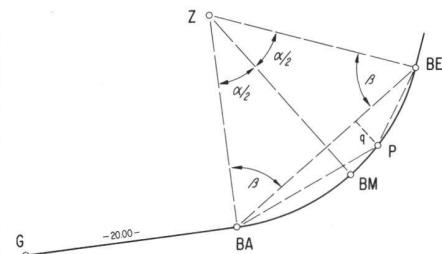
Im Dreieck BA Z BE berechnen wir die Winkel, um das Azimut BA-Z zu erhalten
