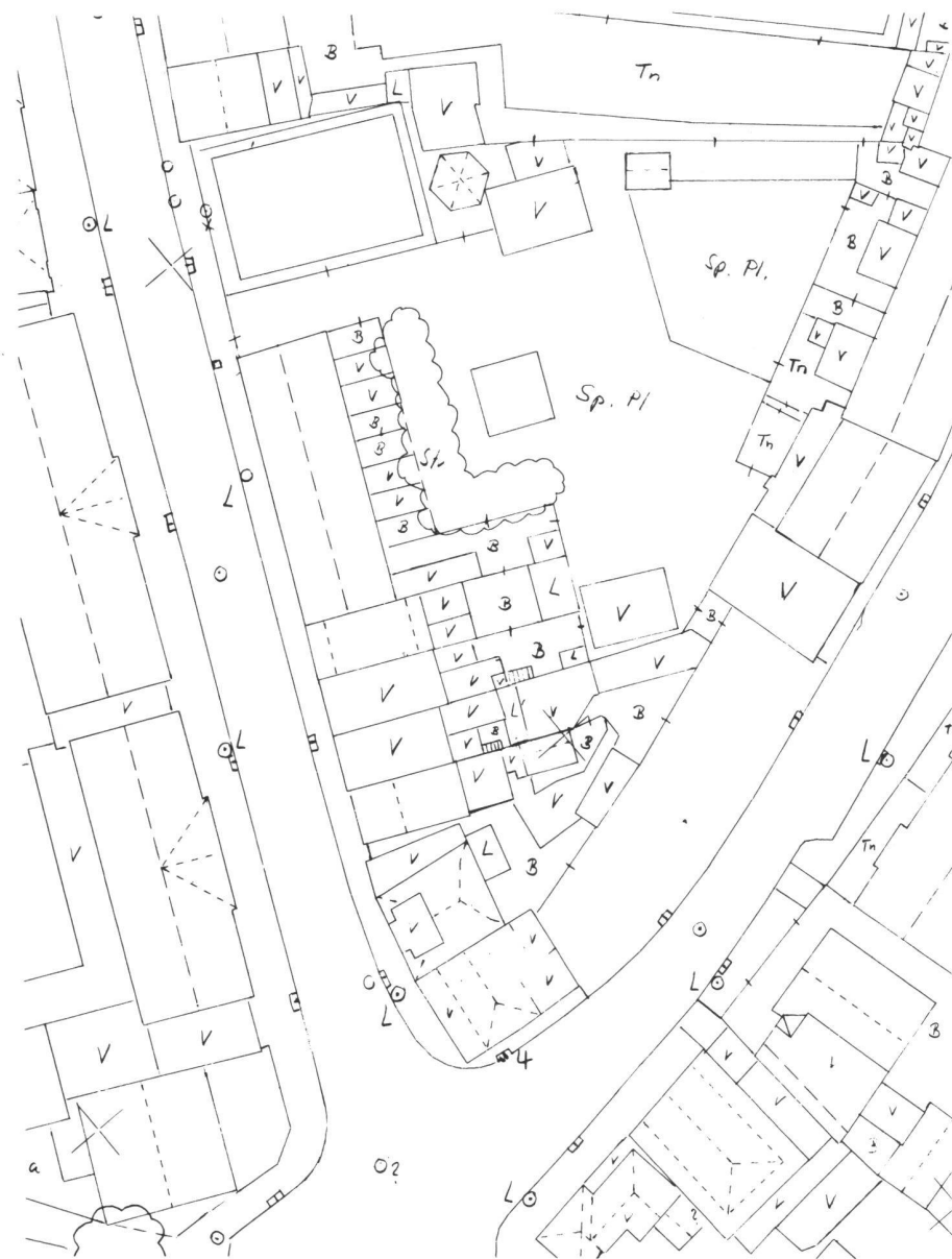
Abb. 12 Maschinenoriginal einer Auswertung mit dem Wild Aviotab TA
