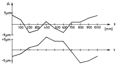
Abb. 5 Geradheit der X- und Y-Führungen am TA Nr. 4715. Die mittels eines genauen Stahllineales festgestellten Fehler sind kleiner als  $5\,\mu$  m.
