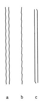
Abb. 8 Störungen im Linienverlauf a. Welligkeit b. Stufigkeit und c. Haken
