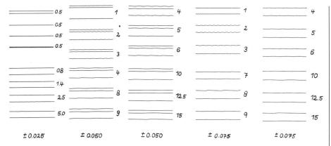
Abb. 9 Linien mit verschieden grosser Welligkeit und Stufigkeit. Die Zahlen unter den Linien bedeuten die Amplitude (a), diejenigen neben den Linien die Wellenlänge ( $\lambda$ ). Die Masseinheit ist jeweils Millimeter.
