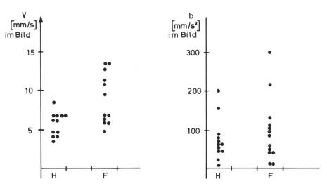
Abb. 2 Maximale Geschwindigkeiten v und Beschleunigungen b bezogen auf das Bild bei linienweiser Auswertung, gemessen am Gerät Aviomap AMU (X-Achse) und verschiedenen topographischen Objekt- und Schichtenlinien H...Handradführung, F... Freihandführung
