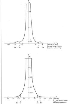
Abb. 3 Häufigkeitsverteilung von Geschwindigkeit und Beschleunigung im Verlauf einer 1-stündigen Auswertung mit dem Gerät Aviomap AMH, gemessen an der X-Achse des Zeichentisches TA. (Kartierung von Schichtenlinien, einigen Situationslinien sowie den notwendigen Transportbewegungen unter Benutzung von Freihand- und Handradführung der Messmerke)
