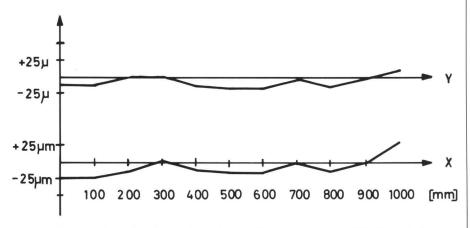
Abb. 6 Absolute Fehler im Massstab der Achsen X und Y des TA Nr. 4715. Die mittels eines Glasmassstabes festgestellten Fehler sind kleiner als 25  $\mu$  m.
