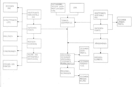
der auf die im Interessenstreifen erhobenen Geländedaten zurückgegriffen wird. Alle Zwischenresultate wie Axführung, Geländeprofile, Längen- und Querprofile, Grundriss und Massenbilanz können automatisch grafisch dargestellt werden.
