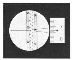
Abb. 2 Höhenablesung mit Mikrometer 128, 732 cm
