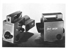
Abb. 1 Kern GK 2-A, neues automatisches Universalnivellier ohne Mikrometer (rechts), mit aufgestecktem Mikrometer (links)
