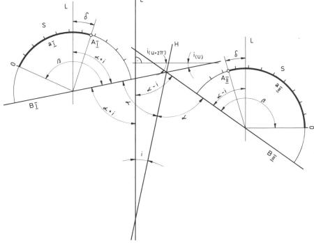
Abb. 5 Schema der Neigungsmessung eines Theodolits Die Indices bezeichnen die Fernrohrlagen. Zusätzlich zu den in Abb. 4 eingeführten Bezeichnungen kommen: H Winkelhalbierende zwischen den beiden Auflagen;  $\alpha$  Winkel zwischen einer Auflage und der Winkelhalbierenden; i Neigung der Winkelhalbierenden gegenüber dem Lot
