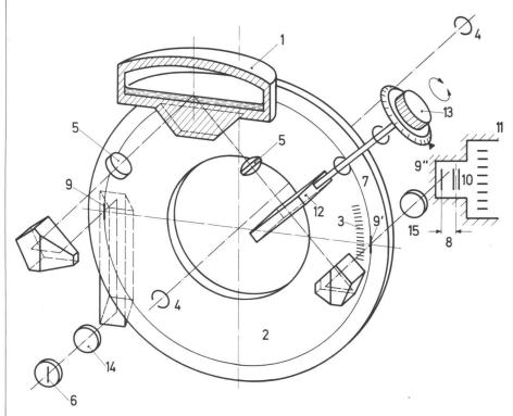
Abb. 2 Schema von Optik und Mechanik des Kippachsmikrometers 1 Flüssigkeitskompensator; 2 Teilungsebene des Höhenkreises; 3 Teilung; 4 Kippachse; 5 optisches System zur Abbildung einer Kreisstelle auf die diametral gegenüberliegende; 6 Strichplatte; 7 Hilfskreise; 8 Abstand, der sich linear mit der Neigungsänderung verändert; 9, 9', 9" aufeinanderfolgende Bilder der Strichplatte 6; 10 Doppelstrich; 11 Gesichtsfeldblende; 12 Planplatte; 13 Mikrometerknopf mit Skala; 14 Abbildungsobjektiv.
