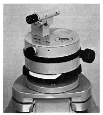
Die vollständig neu konzipierte Stativbussole Wild B3 ist ein Präzisionskompass zur Bestimmung von Magnetisch Nord für Richtungsmessungen. Sie wird von Vorteil dort eingesetzt, wo es auf Geschwindigkeit und kleines Gewicht (nur 800 g) ankommt, also beim Messen einfacher Bussolenzüge, Anfertigen von Lageskizzen durch Geographen und Förster, Orientieren von Windmessern, Ausrichten stationärer Antennenanlagen, Kontrollieren von Kompassen aller Art, Be-
