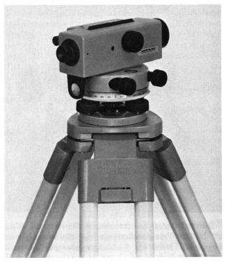
Der Vorteil des neuen Ingenieur-Nivelliers Wild N1 liegt ausser dem günstigen Preis in seinen vielfältigen Einsatzmöglichkeiten, wie Liniennivellements beim Bau von Strassen, Eisenbahnen, Rohrleitungen, Beund Entwässerungsanlagen, Flächennivellements aller Art,
