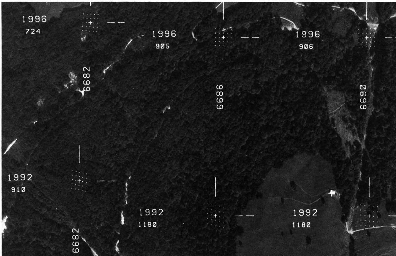
Abb. 4 Vergrößerung eines Luftbildes mit einkopiertem Stichprobenraster, wie es für die Belange des Landesforstinventars verwendet werden soll. Das Mittenkreuz kennzeichnet die genaue Lage des Stichprobenzentrums für die terrestrischen Erhebungen; mit dem 25-Punkt-Raster wird die Überschirmung bei aufgelösten Beständen bestimmt und dient zum Entscheid, ob die Stichprobe effektiv auf Waldgebiet entfällt. Die Ziffern geben die Koordinatenwerte (100 m) und die Höhe der Probe an,
