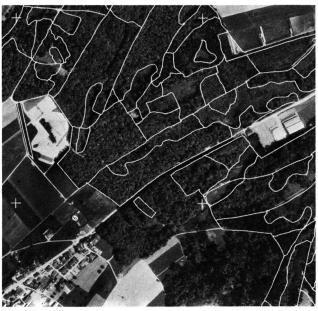
Abb. 2 Überlagerung eines Luftbildes (Aufnahmemassstab 1:25 000) neueren Datums mit einer fünf Jahre früher erstellten Bestandeskarte. Deutlich lassen sich die inzwischen vorgenommenen Verjüngungen erkennen und auch nachtragen. Für die Bildüberlagerung wurde das Lineament der digitalen Bestandeskarte projektiv verzerrt und der Geometrie des Luftbildes angepasst (Aufnahmen Eidg. Landestopographie Bern, reproduziert mit Bewilligung vom 23. 8. 1978).
