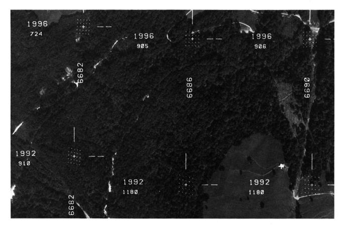
Abb. 4 Vergrösserung eines Luftbildes mit einkopiertem Stichprobenraster, wie es für die Belange des Landesforstinventars verwendet werden soll. Das Mittenkreuz kennzeichnet die genaue Lage des Stichprobenzentrums für die terrestrischen Erhebungen; mit dem 25-Punkt-Raster wird die Überschirmung bei aufgelösten Beständen bestimmt und dient zum Entscheid, ob die Stichprobe effektiv auf Waldgebiet entfällt. Die Ziffern geben die Koordinatenwerte (100 m) und die Höhe der Probe an,
