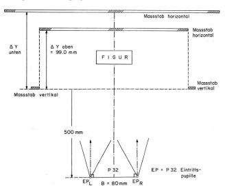
Abb. 5 Grundriss der Aufnahmeanordnung
