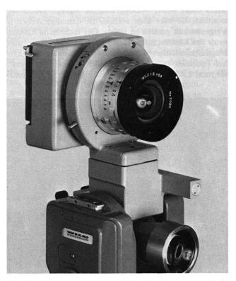
Abb. 3 Terrestrische Kammer Wild P 32 für topographische Aufnahmen
