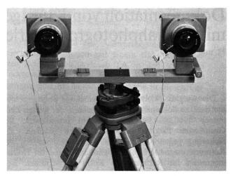
Abb. 4 Zwei P 32 auf dem Basisträger Wild PBA 32 für Nahaufnahmen
