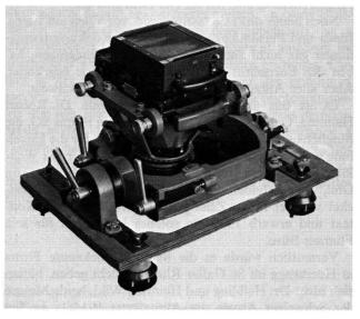
Abb. 3 Fliegerkammer C2 mit aufgesetztem Plattenmagazin
