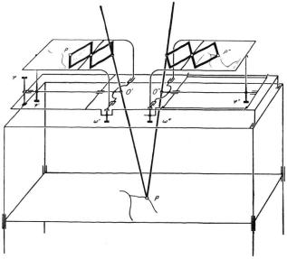
Abb. 6 Prinzipschema des Kartiergerätes A6
