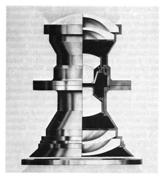
Abb. 7 Schnitt durch das Weitwinkelobjektiv Aviogon f/5.6
