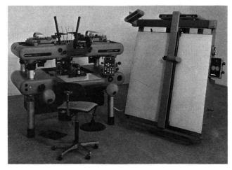
Abb. 11 Aviomap-Gerät AM H mit Zeichentisch Aviotab TA
