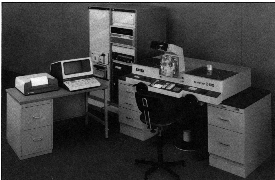
PLANICOMP C 100 mit Kompaktrechner HP 21 MX, Lochstreifenleser und Lochstreifenstanzer.
