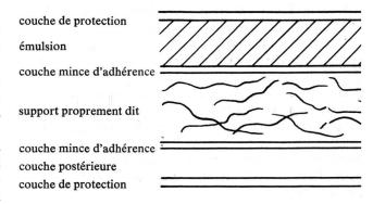
Pour augmenter l'adhérence de l'encre sur les films qui portent déjà du dessin (films cadastraux, plans d'ensemble, etc.) il est recommandé de recouvrir le nouveau dessin avec une laque de protection (par exemple CEDE, Collioud, Berne). On la pose avec un pinceau plat et tendre. Le diluant est de l'éther acétique. En tout temps on peut dessiner sur la laque à condition de passer la gomme crayon au préalable. La laque-spray est moins indiquée car on arrive à un gaspillage de produit.
