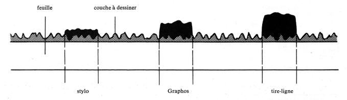
Nous voyons sur la figure qu'avec le tire-ligne on obtient la plus grosse quantité d'encre. Une fois l'encre séchée, le trait devient impeccable et bien couvrant. Avec le tire-ligne Graphos, le débit est un peu moins grand, mais le trait est encore suffisamment couvrant. Avec les stylos et les plumes Graphos, cela devient problématique car l'encre est déposée en forme de spatule et il en résulte un trait gris qui n'est pas couvrant.
