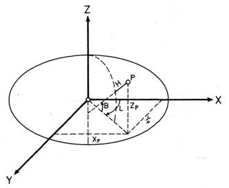
Abb. 1 Das Rotationsellipsoid als klassische geodädtische Bezugsfläche und das geozentrische kartesische Koordinatensystem.
