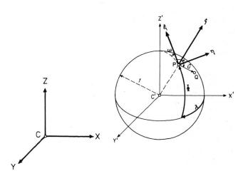
Abb. 2 Richtungskugel durch P zur Darstellung der Transformation des Vektors PQ vom geozentrischen ins lokale kartesische Koordinatensystem.
