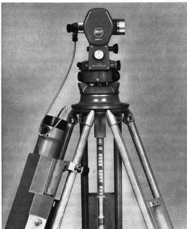
Der Lasertheodolit bietet den entscheidenden Vorteil, dass durch die ständige Sichtbarkeit am Empfangsort die Ziellinie an der Messstelle selbst gefunden werden kann. Da sich der Laserstrahl mit Hilfe von Winkelwerten sekundengenau ausrichten lässt, ist der Lasertheodolit das geeignete Gerät zur Vermessung und zur Steuerung der Vortriebsmaschinen sowie für Kontrollen im Tunnel- und Stollenbau.
