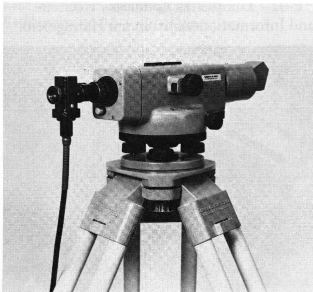
Der reduzierende *Infrarot-Tachymeter Wild Distomat DI3S* misst vollautomatisch Distanzen in wenigen Sekunden mit einer Genauigkeit von  $\pm 5 \text{ mm}$  und zeigt auf
