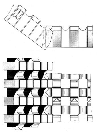
Abb. 5 UK-Stein: Übergang von Sohle zur Böschung. Man beachte die Normalverzahnung der Steine in der Sohle sowie die scharnierartige Verbindung Böschung-Sohle
