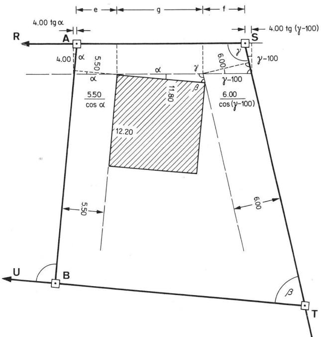
Gegeben:  $\alpha = 5^\circ 44'$ ,  $\beta = 81^\circ 43'$ ,  $\gamma = 113^\circ 13'$ , Grenzabstände 6.00, 4.00, 5.50 m, Hausbreite 11.80 m.
