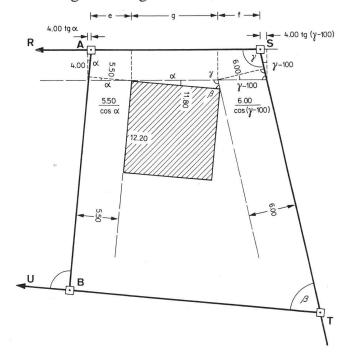
Gegeben:  $a = 5^{\circ}44$ ,  $\beta = 81^{\circ}43$ ,  $\gamma = 113^{\circ}13$ , Grenzabstände 6.00, 4.00, 5.50 m, Hausbreite
