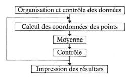
Cette structure présente deux avantages. Elle permet d'une part d'introduire dans l'une ou l'autre des phases d'éventuelles modifications sans provoquer de changements dans les phases non concernées. D'autre part, il devient possible de reprendre en tout temps le traitement depuis le début d'une phase quelconque.
