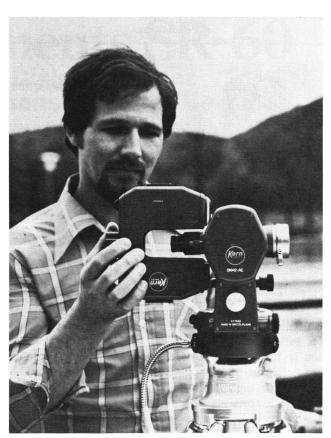
Durch das einfache Aufschieben des DM 501 auf das Theodolitfernrohr entsteht ein handliches elektrooptisches Tachymeter
