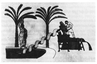
Fig. 2 Vis d'Archimède, rendement: au mieux, un homme, cinq litres par minute
