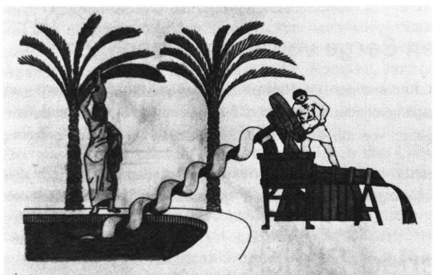
Fig. 2 Vis d'Archimède, rendement: au mieux, un homme, cinq litres par minute
