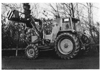
Abb. 1 Der Traktor mit dem aufgebauten Heckenschneider
