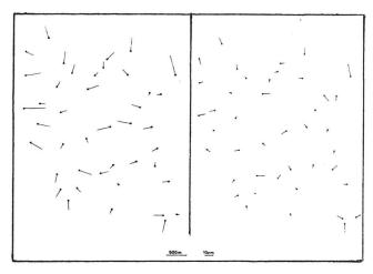
Fig. 8 Ecarts résiduels avant et après une interpolation selon les moindres carrés
