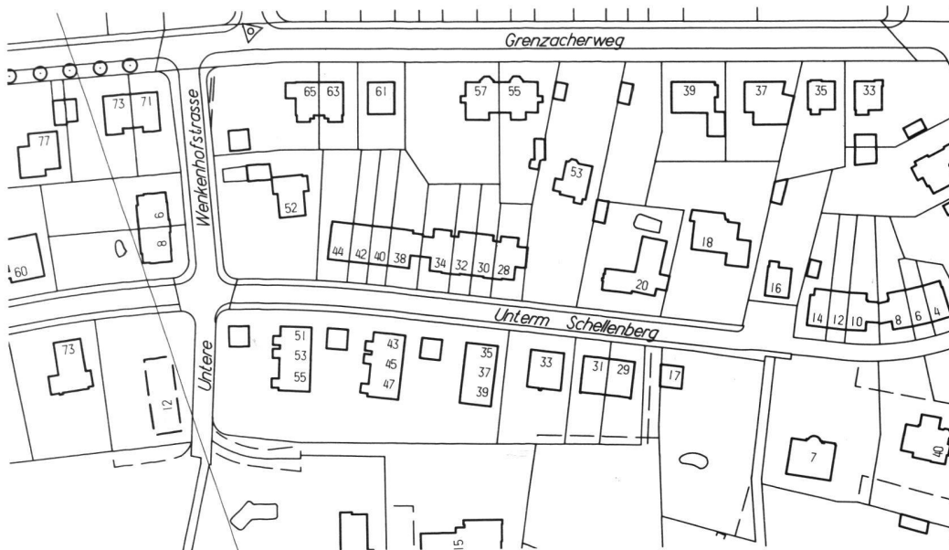
Typ 6: Kanton Basel-Stadt Massstab 1:2000. Automatisch gezeichnet mit Lichtkopf. Abgeleitet aus digitalisierten Grundbuchplänen.
