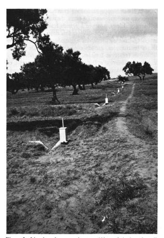
Figure 5 Limnigraphes enregistreurs (déversoirs) dans les olivettes, pour la mesure des débits de ruissellement. Les arbres sont dans des terrasses (manka) superposées.
