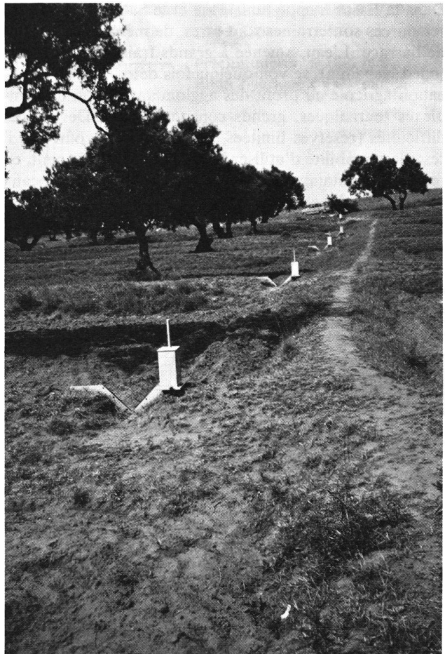
Figure 5 Limnigraphes enregistreurs (déversoirs) dans les olivelettes, pour la mesure des débits de ruissellement. Les arbres sont dans des terrasses (manka) superposées.
