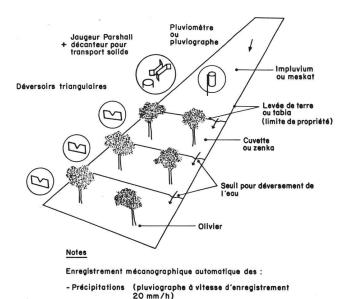
Figure 6 Schéma du système hydrologique «meska» d'utilisation des eaux de ruissellement et schéma du dispositif de mesure.
