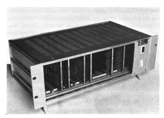
Abb. 2 Ein Microcomputer der Firma Martin Luther Elektronics, Zürich. Aussenmasse  $48 \times 14 \times 25$  cm, interner Speicher max. 64 KB, Zykluszeit 1 µsec. Solche oder ähnliche Computer werden zum Bau von Kleinsystemen verwendet. Sie werden vor allem für Prozesssteuerungen oder für die Unterstützung der Datenerfassung in der kommerziellen EDV eingesetzt.
