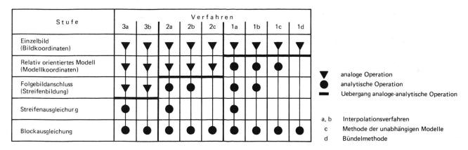
Tabelle 1 Übersicht über Methoden der photogrammetrischen Fixpunktverdichtung
