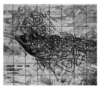
Abb. 2 Interpolationskurven der y-Differenzen, 2 cm Äquidistanz, Varianz für die Filterung ± 7 mm. Die ehemalige Polygonierung in den hangparallelen Strassen besass kaum Querverbindungen. Dies zeigt sich nun im Kurvenbild (Kurveninterpolation: Coradi AG, Zürich).
