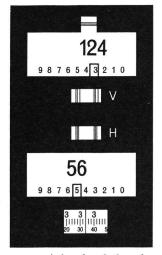
Abbildung 2 Das Kippachsmikrometer wird anhand des einfachen und des doppelten Striches in der Ausbuchtung im Ablesefeld für die Bezifferung des Vertikalkreises eingestellt (links nicht eingestellt, rechts eingestellt)
