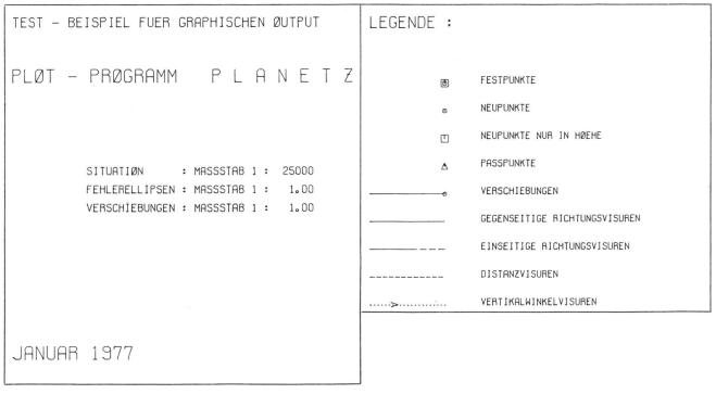
Anwendungsbeispiel zum Plotprogramm PLANETZ: Kleines erzeugte Titelblatt und die Legende sind hier verkleinert abge-Netz mit Richtungs- und Höhenwinkelmessungen sowie Distanzen. Die Verschiebung des Lageneupunktes und dessen mittlere Fehlerellipse sind ebenfalls eingezeichnet. Das im Format A4 den Plotter dauerte 5 Minuten.
