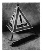
TRIOPAN-Faltsignale für Vermessungs- oder Bauingenieure werden als die schnellsten und wirksamsten Signale für vorübergehende Signalisation und raschen Einsatz angesehen. Diese sind erhältlich in den Grössen von 60, 70, 90 und 110 cm Schenkelänge des roten Dreiecks. Die Ausführung aus wetterfestem Kunstfasergewebe, kälte- und wärmefest, rostgeschützten Stativen, selbstöffnende Konstruktion, kleiner Platzbedarf in geschlossenem Zustand zeichnen die TRIOPAN-Faltsignale aus.
