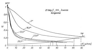
Abb. 10 MTF-Kurven des Objektivs 21NAgII, f/4, für weisses Licht und Schwellwert SW; Bildwinkel =  $0^{\circ}$ ,  $16.4^{\circ}$ ,  $23.8^{\circ}$ ,  $29.9^{\circ}$  und  $33.5^{\circ}$
