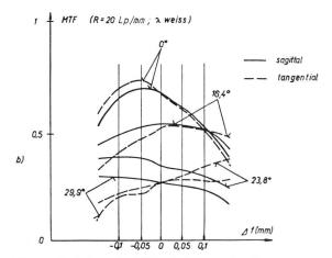
Abb. 8 Variation der MTF beim Defokussieren für verschiedene Bildwinkel, bei der Ortsfrequenz von 20 Lp/mm
