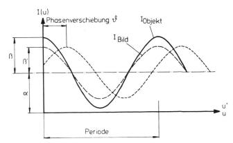
Abb. 1 Prinzip der optischen Übertragungsfunktion
