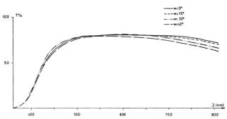
Abb. 6 Transmissionskurve des Universal Aviogon
