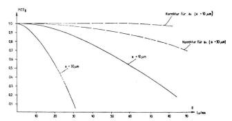
Abb. 12 MTF der durch Bildbewegung bedingten Bildverschmierung
