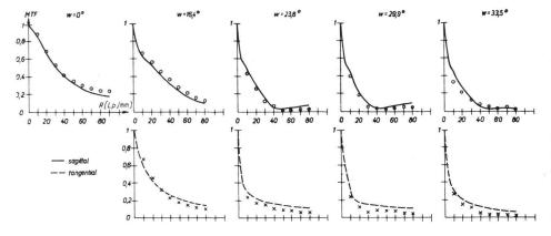
Abb. 9 Vergleich der Rechnung und Messung der MTF des Objektivs 21NAgII für weisses Licht und die beste Bildebene
