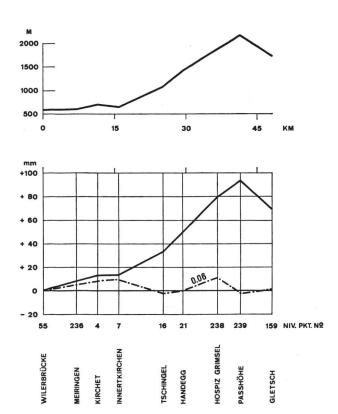
Abbildung 5 Höhenänderungen längs des Nivellementes über die Grimsel
