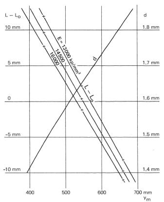
Abb. 2 Die an der Länge  $L_{\rm o}$  anzubringende Korrektur  $L-L_{\rm o}$  in Abhängigkeit von Durchhang  $y_{\rm m}$  und E-Modul E
