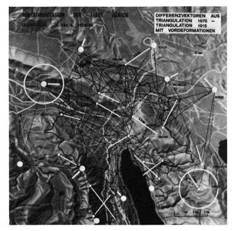
Abb. 5 Um Einblick zu gewinnen in das Verhalten der Richtungs- und Streckenmessungen nach der Ausgleichung werden alle Verbesserungen über dem doppelten mittleren Fehler kartiert.
