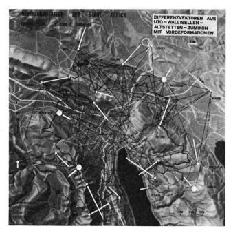
Abb. 4 Mit einer Verkürzung bzw. Verlängerung der beiden Basen um 5 cm wird das Netz nahezu spannungsfrei über 4 Punkte gelagert (vgl. Abb. 2 und 3).
