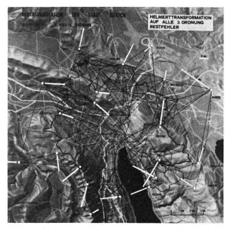
Abb. 1 Mit den Anschlusspunkten Uto und Wallisellen wird das kombinierte Netz III. und IV. Ordnung ausgeglichen und auf 21 TP III. Ordnung nach Helmert transformiert.
