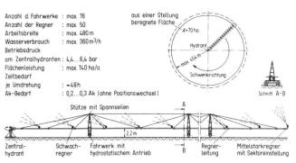
Abb. 7 Kreisberegnungsmaschine Fregat
