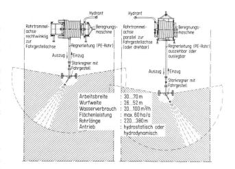
Abb. 3 Beregnungsmaschine mit Regnereinzug - Verfahrensablauf
