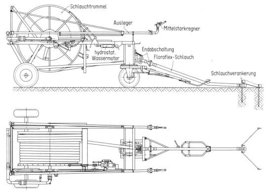
Abb. 5 Beregnungsmaschine mit Maschinenvorschub - Geräteführung über Regnerleitung
