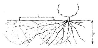
Fig. 2 Règle pour l'espacement (d) entre émetteurs: d = 2 r = 2 (p-h)
