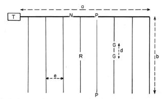
Fig. 4 Les paramètres servant au calcul du coût de l'installation T: ensemble de tête du réseau
