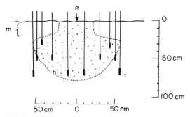
Fig. 1 Profil d'un bulbe humecté par goutteur (e), dans un sol où les 20 premiers centimètres (m) sont motteux; (t): positions des tensiomètres lors de l'essai; (h) fort d'humectation.
