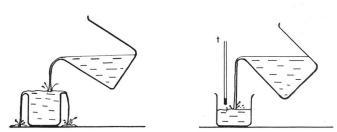
Fig. 3 La dose d'arrosage ne doit pas se calculer sur l'ETP (a gauche), mais sur la capacité d'absorption du bulbe à humecter (à droite). Un tensiomètre (t) renseigne sur l'humidité du bulbe.
