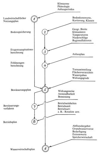
Abb. 2 Flussdiagramm zur Berechnung des Wasserbedarfes (vereinfacht)
