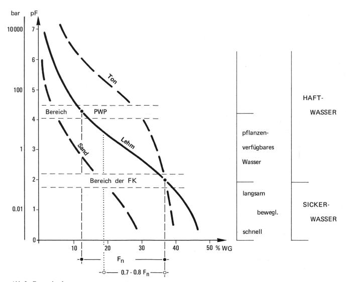
Abb. 3 Desorptionskurven Rechenbeispiel für einen Lehmboden
