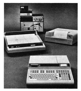
Erweitertes Programmier-ROM, Matrix-ROM, Plotter-ROM, Universal-I/O-ROM, Erweitertes I/O-ROM. Die hohe Verarbeitungsgeschwindigkeit dieses Tischrechners wird durch die von Hewlett-Packard entwikkelte N-MOS-Schaltung der zweiten Generation erreicht.
