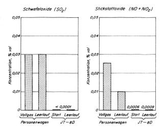
Abb. 4 Vergleich zwischen Abgasbestandteilen eines typischen englischen Personenwagens und eines DC-9-Triebwerkes (Pratt & Whitney JT-8D). Quellen: Personenwagen «SAE-Journ.» 77 (1969), Nr. 6; Triebwerk JT-8D EMPA-Bericht Nr. 61847/1968 (erschienen in der Schweizerischen Bauzeitung, Heft 2/1971).
