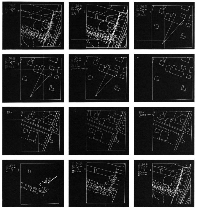
Abb. 3 Illustration zur Arbeitsweise von GRACOS Die ersten sechs Aufnahmen zeigen das Verschieben eines Punktes mit dem Strichkreuz. Innerhalb eines erst zum Teil korrigierten Datensatzes (erstes Bild) wird ein grober Fehler erkannt. Mit dem Strichkreuz wird ein neues Zentrum definiert (2). Danach wird das Deckblatt Nr. 41, welches das fehlerhafte Objekt enthält, stark vergrössert aufgezeichnet, und der zu verschiebende Punkt wird identifiziert (3). Schliesslich wird die neue
