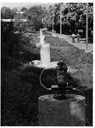
Abb. 1 Blick vom Pfeiler 0 auf die Prüfstrecke: Di 3 S auf der Zentrierplatte mit <sup>5</sup>/s"-Schraube für diverse Instrumentenadapter.
