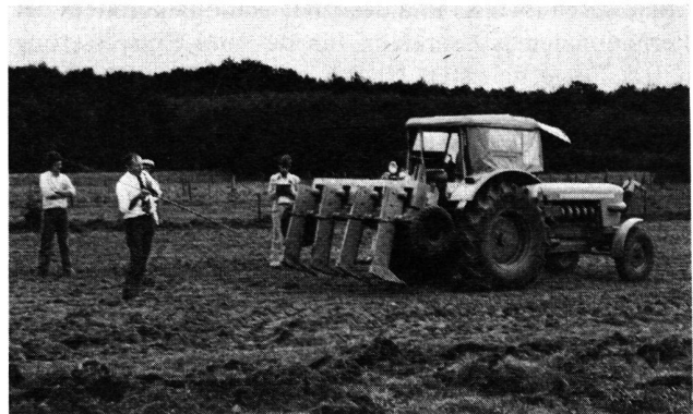
Abb.3 Hubschwenklockerer . Beim Hubschwenklockerer wird das Lockerungsschwert über die Zapfwelle in Fahrtrichtung nach vorn und hinten bewegt. Ein grosser Teil des Kraftbedarfs wird über die Zapfwelle erbracht.
