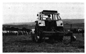
Abb. 1 Starres Lockerungsgerät. Die Demonstration zeigte deutlich, dass der Kraftbedarf für starre Geräte sehr gross ist und somit kaum auf die wünschbare Lockerungstiefe von 80 cm gearbeitet werden kann.
