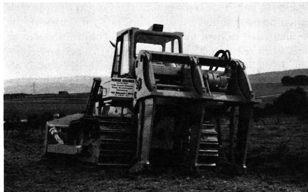
Abb.4 Stech-Hub-System . Bei dieser neuesten Entwicklung wird der Lockerungseffekt sowohl durch vertikale wie senkrechte Bewegungen des Lockerungsaggregates erzielt. Das 3armige Gerät arbeitet auf eine Breite von 2,4 m. Als Zugerät dient eine Planierraupe. Es wurden damit die bisher überzeugendsten Tieflockerungsarbeiten ausgeführt.
