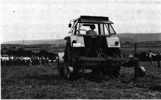
Abb.1 Starres Lockerungsgerät . Die Demonstration zeigte deutlich, dass der Kraftbedarf für starre Geräte sehr gross ist und somit kaum auf die wünschbare Lockerungstiefe von 80 cm gearbeitet werden kann.
