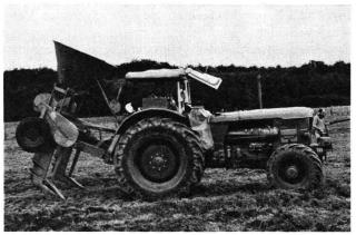
Abb. 2 Wippscharlockerer (hier kombiniert mit einer Tiefdüngungsanlage). Das bewegliche Lockerungsschar wird über ein Gestänge von der Zapfwelle angetrieben. Die Lockerungswirkung ist gegenüber dem starren Gerät erheblich stärker, der Zugkraftbedarf aber immer noch sehr gross.
