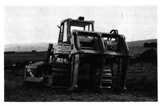
Abb. 4 Stech-Hub-System. Bei dieser neuesten Entwicklung wird der Lockerungseffekt sowohl durch vertikale wie senkrechte Bewegungen des Lockerungsaggregates erzielt. Das 3armige Gerät arbeitet auf eine Breite von 2,4 m. Als Zuggerät dient eine Planierraupe. Es wurden damit die bisher überzeugendsten Tieflockerungsarbeiten ausgeführt.
