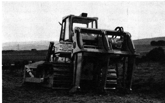
Abb.4 Stech-Hub-System . Bei dieser neuesten Entwicklung wird der Lockerungseffekt sowohl durch vertikale wie senkrechte Bewegungen des Lockerungsaggregates erzielt. Das 3armige Gerät arbeitet auf eine Breite von 2,4 m. Als Zugerät dient eine Planieraupe. Es wurden damit die bisher überzeugendsten Tieflockerungsarbeiten ausgeführt.
