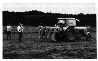
Abb. 3 Hubschwenklockerer. Beim Hubschwenklockerer wird das Lockerungsschwert über die Zapfwelle in Fahrtrichtung nach vorn und hinten bewegt. Ein grosser Teil des Kraftbedarfs wird über die Zapfwelle erbracht.
