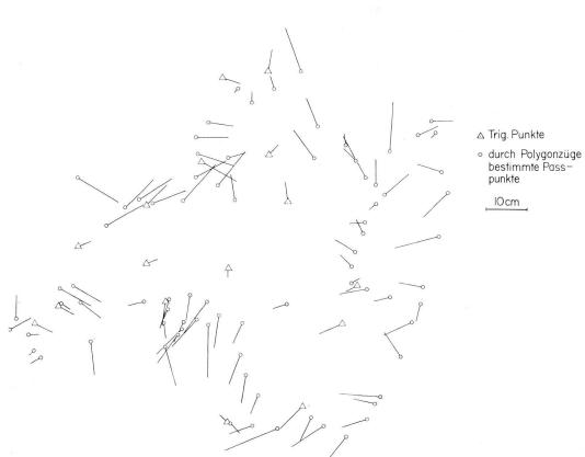
Abb. 3 Verbesserungen an den Passpunkten vor Interpolation.
