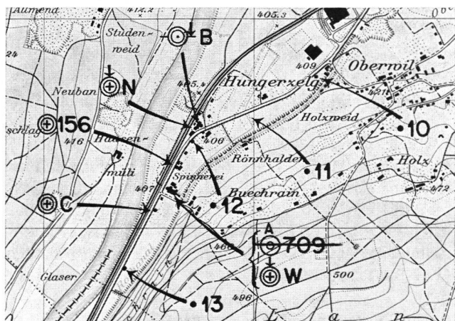
Abb. 1 Ausschnitt aus einer Punktkarte des Landesnivellements. Sie gibt Auskunft über ungefähre Lage und Verteilung der Fixpunkte. (Reproduziert mit Bewilligung der Eidg. Landestopographie vom 23. 6. 1976.)
