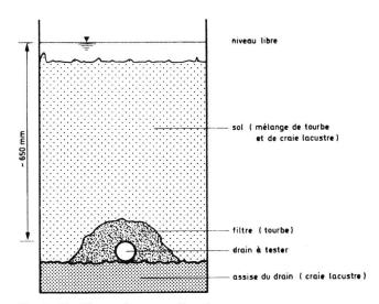
Fig. 1 Profil-type des cuves d'essai
