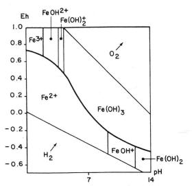
Fig. 4 Diagramme d'équilibre des formes de fer en fonction de Eh et pH
