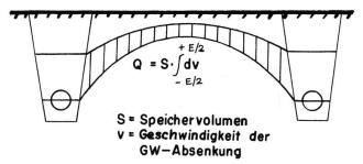
Abb. 1 System der GW-Absenkungen (schematisch)
