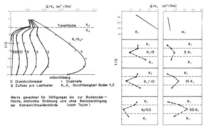
Abb. 4 Abhängigkeit des Drainzuflusses von der Draintiefe und den Durchlässigkeiten in mehreren Bodenzonen
