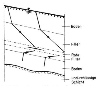
Abb. 8 Längsströmung im Filter bei geneigtem Gelände (schematisch)
