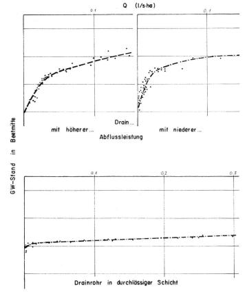
Abb. 6 Beziehung Grundwasserstand (GW) zu Drainabfluss (q), (Messwerte nach F. Feichtinger)
