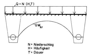
Abb. 2 System des kritischen GW-Spiegels (schematisch)
