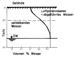
Abb. 3 Endzustand der GW-Absenkung (schematisch)
