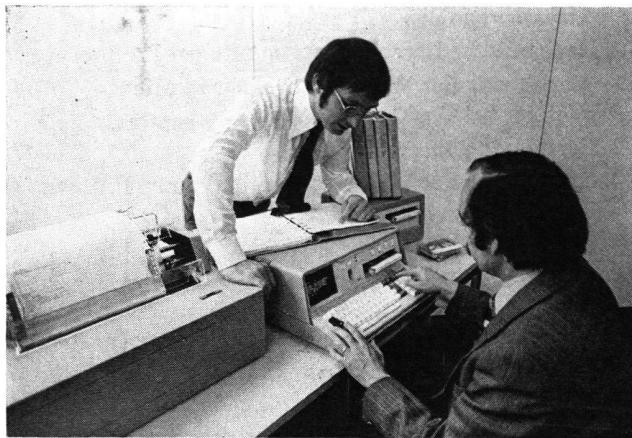
denen Ausbaustufen von 16 K- bis 64 K-Bytes Grösse erhältlich. Für die APL- und BASIC-Sprachübersetzer sowie für die Systemsteuerung und -überwachung steht ein «READ ONLY»-Speicher zur Verfügung.
